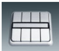
Emetteur radio mural plat, blanc | commande individuelle de 4 canaux ou de 2 canaux et 4 scènes lumineuses L x l x H : 81 x 81 x 17 mm
